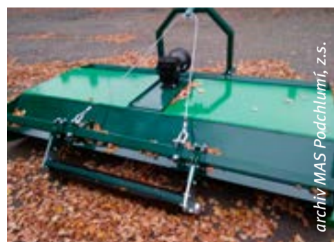
Nesený mulčovač Zdeňka Kráčmara pro údržbu ovocných sadů
